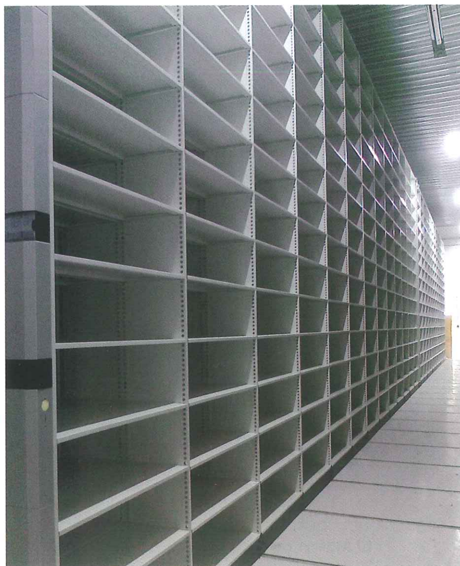
Kompaktarkivreoler i Fælles Museumsmagasiner. Fronten har et andet design men fungerer efter samme princip som kompaktpallereolerne. Foto: Lise Ræder Knudsen
